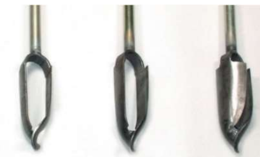
■ Figure 6 : Tarières utilisées pour les sondages pédologiques
